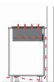
**Set d'installation Plug & Play nécessaire pour les configurations en recyclage sans raccordement.**
